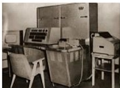
Odra 1001 to pierwsza maszyna cyfrowa opracowana w ELWRO w latach 1960-1961 w zespole Jana Markowskiego. Komputer nie został wdrożony do produkcji ze względu na niskie parametry niezawodnościowe.
